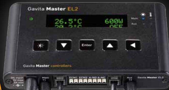
Niederspannungs-Versorgungsanschluss, Universaladapter für 120-240 V.
