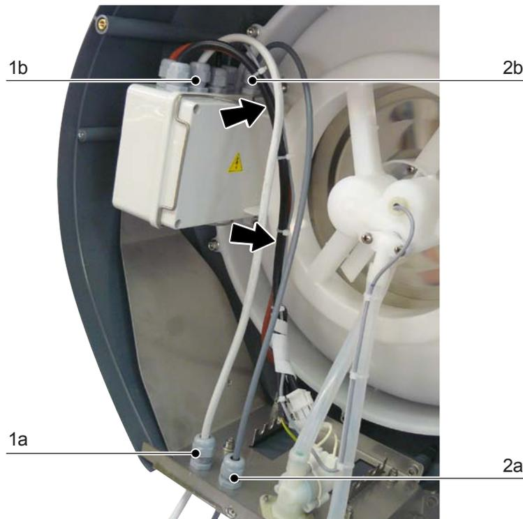
Das Kabel der Spannungsversorgung durch die Stopfbüchse "1a" ins Gerät und durch die Stopfbüchse "1b" in die Anschlussbox führen und gemäss dem Schema auf dem Steuerprint anschliessen.
