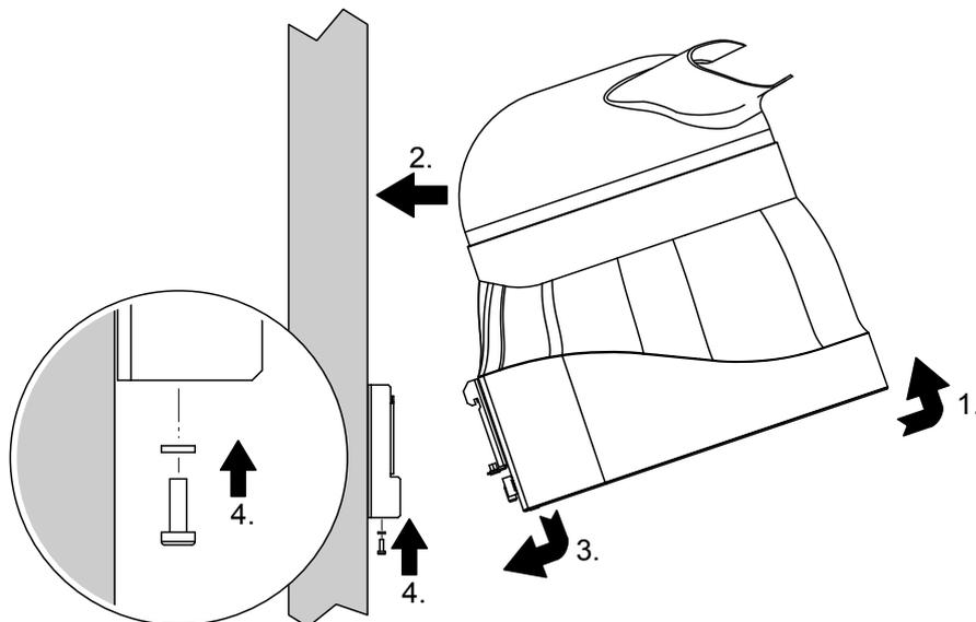
1. Das Gerät bis über die Wandhalterung anheben und leicht nach hinten gegen die Wand kippen.
