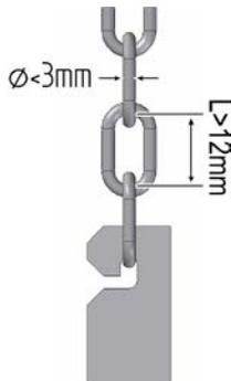
Die drei Ketten zum Aufhängen des Gerätes sind Sache des Kunden. Die Ketten müssen senkrecht über den drei Winkelhaltern (die am Gerät befestigt werden) an die Decke montiert werden. Die Befestigungspunkte und die Ketten müssen eine ausreichende Tragkraft haben, um das Gewicht des Gerätes (siehe Kapitel 9.1 "Technische Daten") zu tragen.
