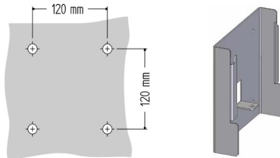
1. Mit Hilfe der Wandhalterung die Befestigungslöcher am vorgesehenen Standort an der Wand anzeichnen. Vor dem Anzeichnen der Befestigungslöcher darauf achten, dass die Wandhalterung genau horizontal ausgerichtet ist.
