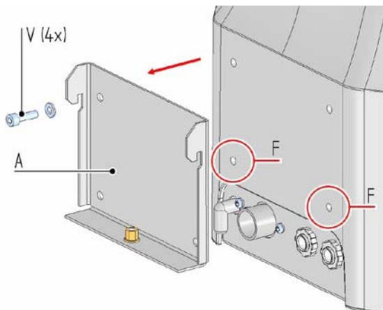
1. Die 4 Schrauben "V" lösen und die Halterung "A" an der Rückseite des Gerätes entfernen. Hinweis: Bewahren Sie die Halterung "A" für eine eventuelle spätere Verwendung auf.
