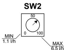
Die Einstellung der Leistungsbegrenzung erfolgt über den Drehschalter SW2 auf dem Steuerprint.
