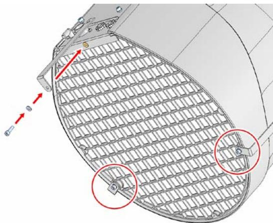
2. Die drei mitgelieferten Winkelhalter für die hängende Montage, wie in der Abbildung gezeigt, mit je einer Schraube und Unterlagscheibe am Gerät befestigen.
