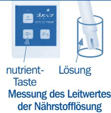
HINWEIS: Der Leitwert-/Temperatur-Messfühler muss mindestens einmal im Monat gereinigt werden, um Salzablagerungen zu entfernen und eine genaue Messung zu gewährleisten. Falls Sie ölige Zusatzstoffe verwenden, muss der Leitwert-/Temperatur-Messfühler nach jeder Benutzung gereinigt werden. Siehe Abschnitt 7.
