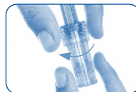
Entfernen der Schutzkappe des pH-Messfühlers
